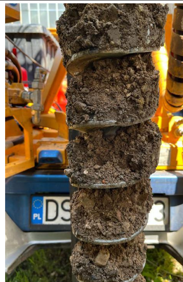
Przykład próby gruntu OW2 głębokość 2,6-3,2 m p.p.t. – żwir piaszczysty
