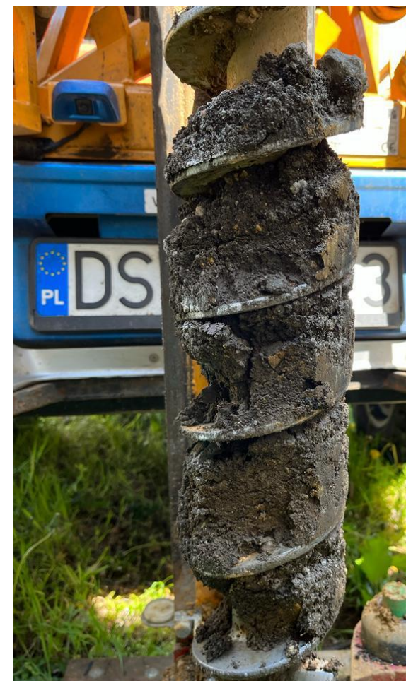
Przykład próby gruntu OW2 głębokość 0,05-1,7 m p.p.t. – nasyp niekontrolowany w składzie: glina piaszczysta z domieszką żwiru przewarstwiona pospółką zaglinioną, humus, szlaka, fragmenty cegieł i szczątek roślin
