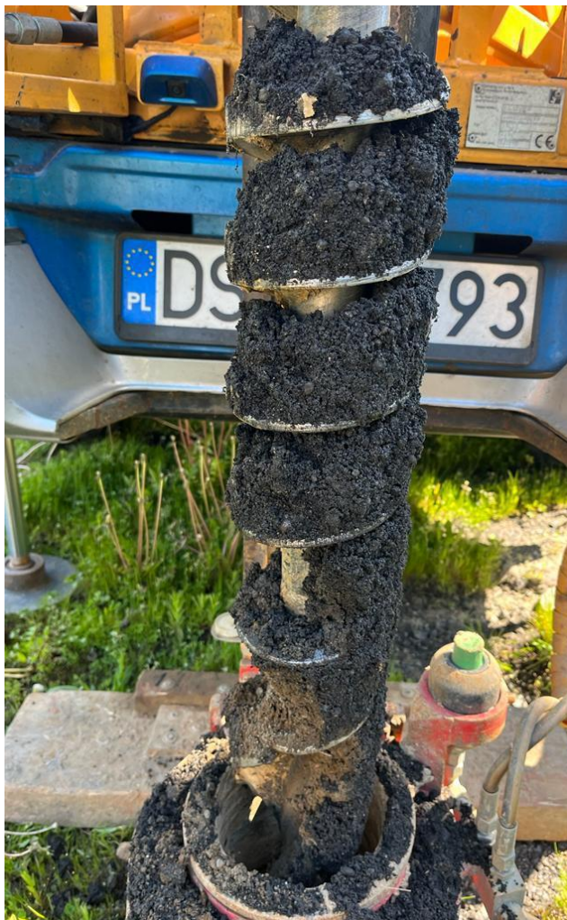
Przykład próby gruntu OW1 głębokość 0,0-0,5 m p.p.t. – nasyp niekontrolowany w składzie: szlaka, fragmenty cegieł
