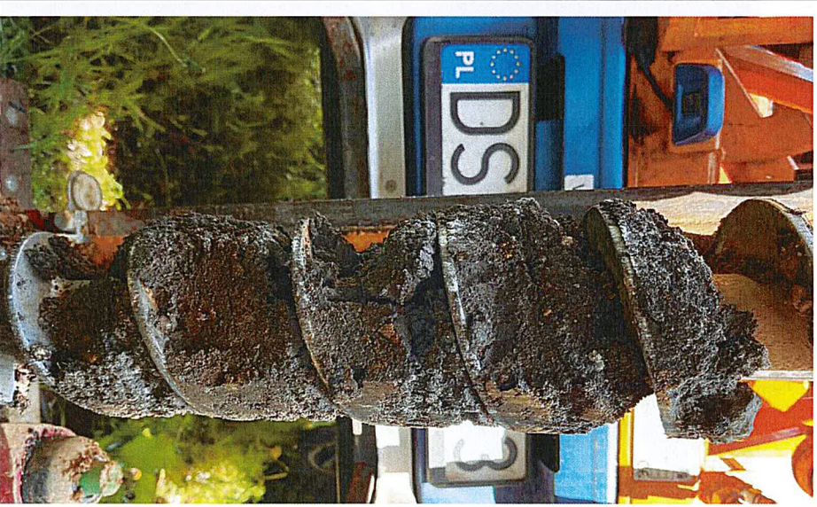
Przykład próby gruntu OW2 głębokość 0,05-1,7 m p.p.t. – nasyp niekontrolowany w składzie: glina piaszczysta z domieszką żwiru przewarstwiona pospółką zaglinioną, humus, szlaka, fragmenty cegieł i szczątki roślin
