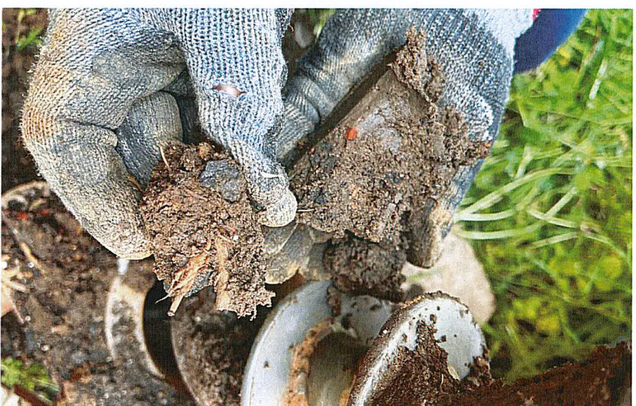
Przykład próby gruntu OW2 głębokość 0,05-1,7 m p.p.t. – szczątki roślin, fragmenty cegieł i szlaki
